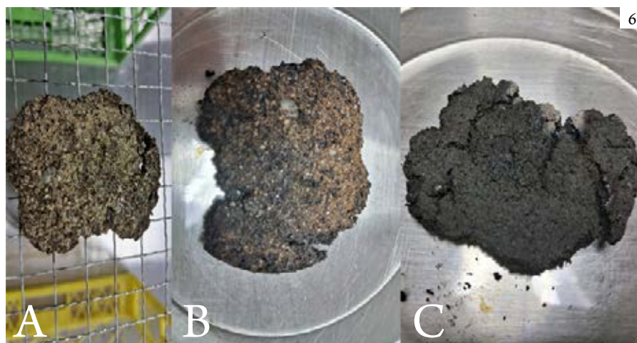
Figura 6 Testeos de fuego. a) Muestra inicial. b) Muestra de superficie no expuesta al fuego. c) Muestra de superficie expuesta al fuego.
