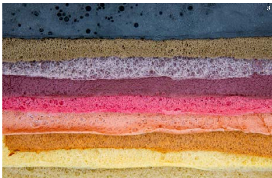
Figura 8 Ejemplo de paleta cromática de bioespumas de gelatina. Su coloración parte de las cargas utilizadas en su formulación. De arriba abajo: carbón activo, ceniza, arroz negro, vino tinto, remolacha, aguacate, cebolla, naranja y liquen.
